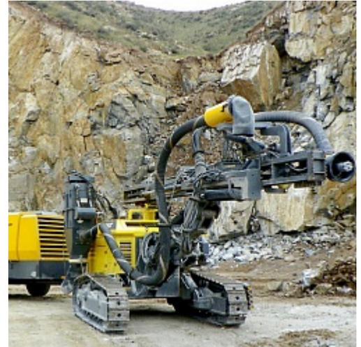
Органы управления **Atlas Copco AirROC D45 SH** разделены на две группы. Управление перемещением смещено к задней части и оператор, управляя установкой, стоит на специальной площадке, имея возможность смотреть в направлении движения. Управление бурением расположено на боковой поверхности установки, и скважина всегда находится в зоне прямой видимости оператора.
